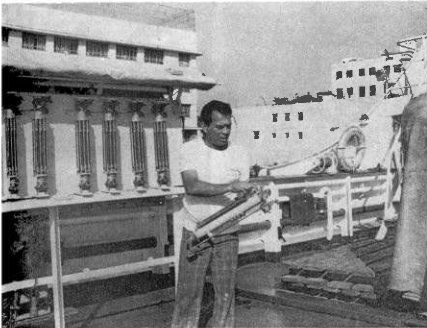
El auxiliar de investigaciones Rainerio Calderón, del Instituto de Oceanología de la Academia de Ciencias de Cuba, nos muestra una de las botellas 'Nansen'
