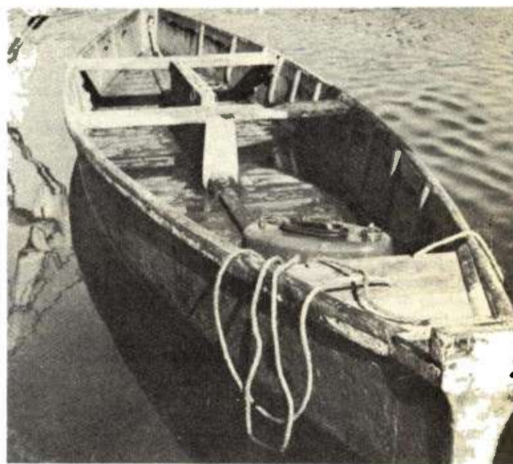
▲ Algunas viejas chalanas de Tunas de Zaza se han contagiado con las nuevas y presentan un macizo y raro codaste que también hace las veces de estrecho espejo de popa donde, en su coronamiento, se instala el motor fuera de borda
