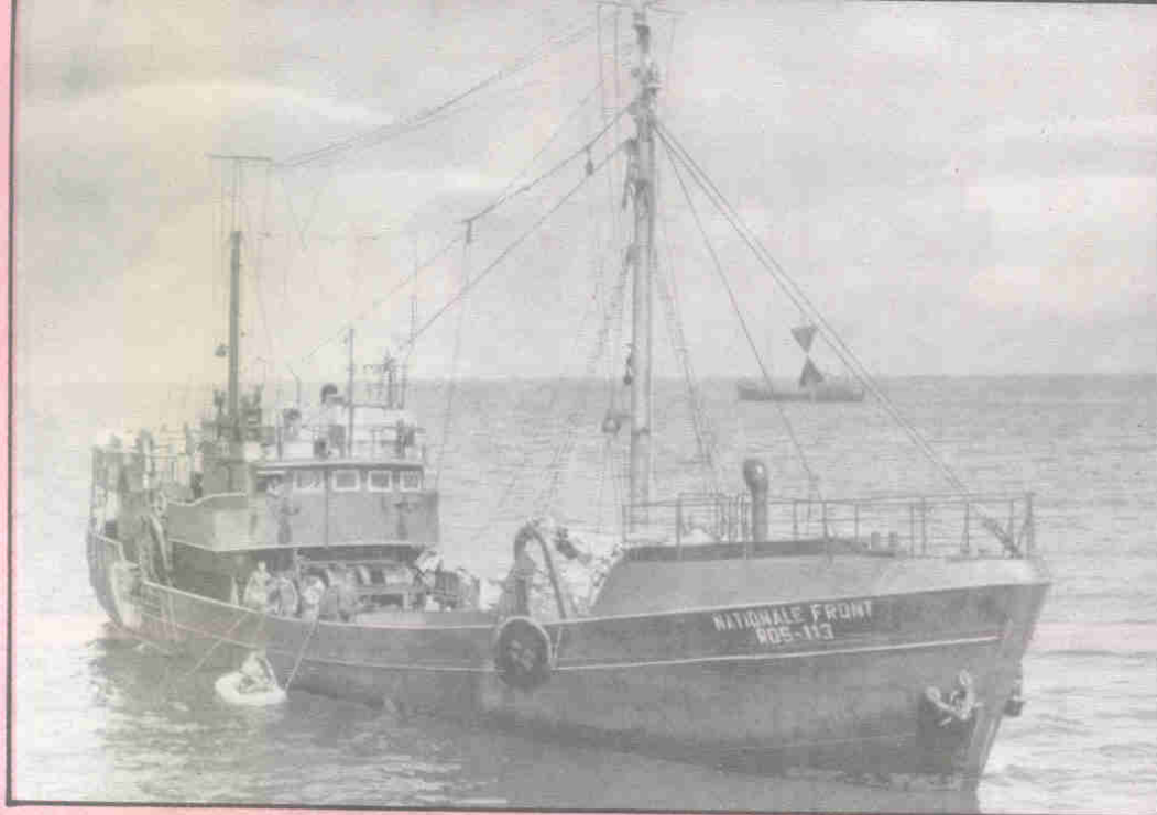
Logger ROS-113 NATIONALE FRONT mit nachgerüsteter Back zur Erhöhung der Seetüchtigkeit. Typisches Erscheinungsbild der DDR-Logger in den letzten Jahren ihrer Einsatzzeit
