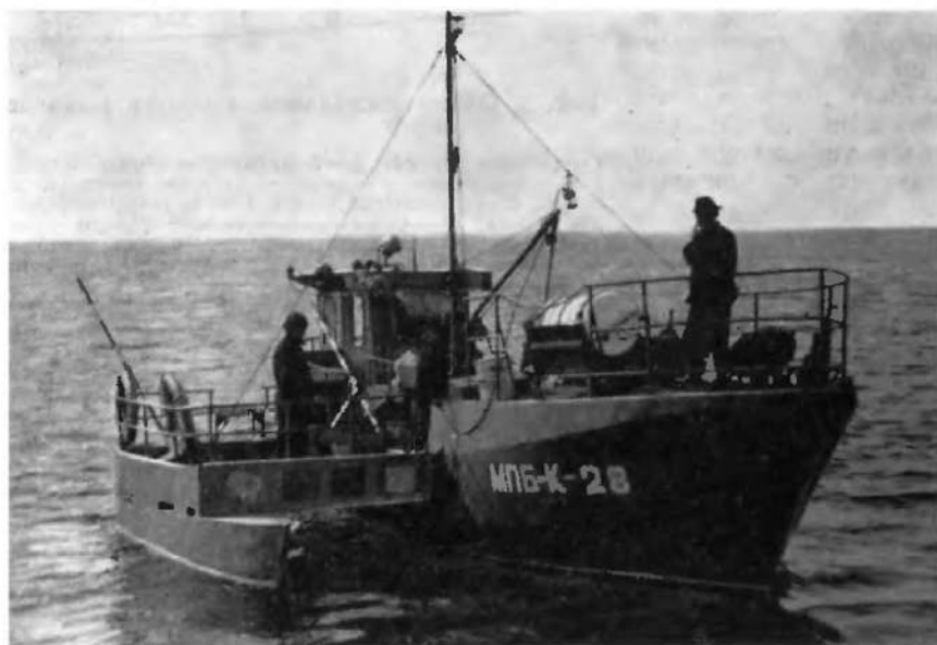
Рис. 2. Малый промысловый бот-катамаран типа МПБ-К-28 во время замеров напряжений в соединительной конструкции.
