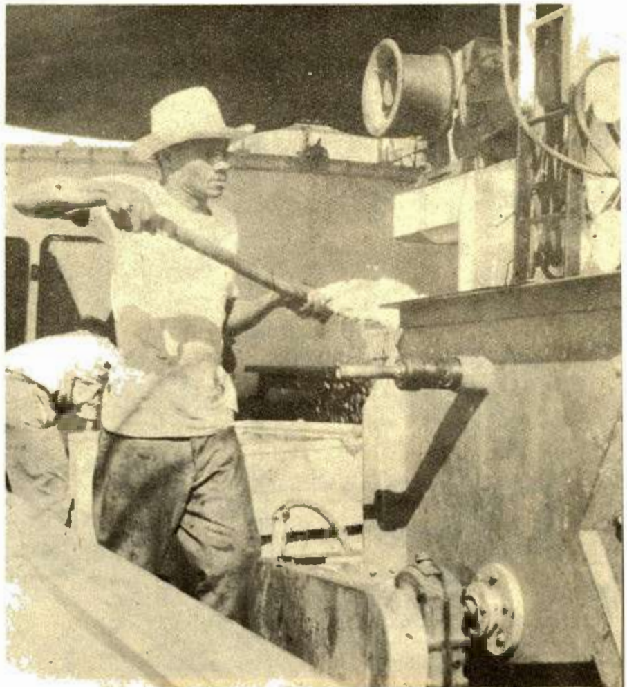
De los tanques, pasa el camarón al elevador de la máquina clasificadora
