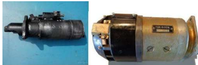
Стартер СТ-25 и генератор ГСК-1500 для дизеля 4ЧСП.
