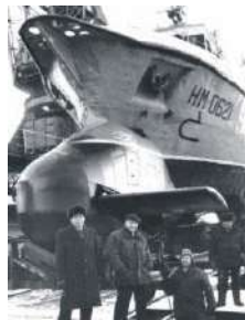
Волновой двигатель в бульбовом обтекателе на траулере типа «Балтика»
